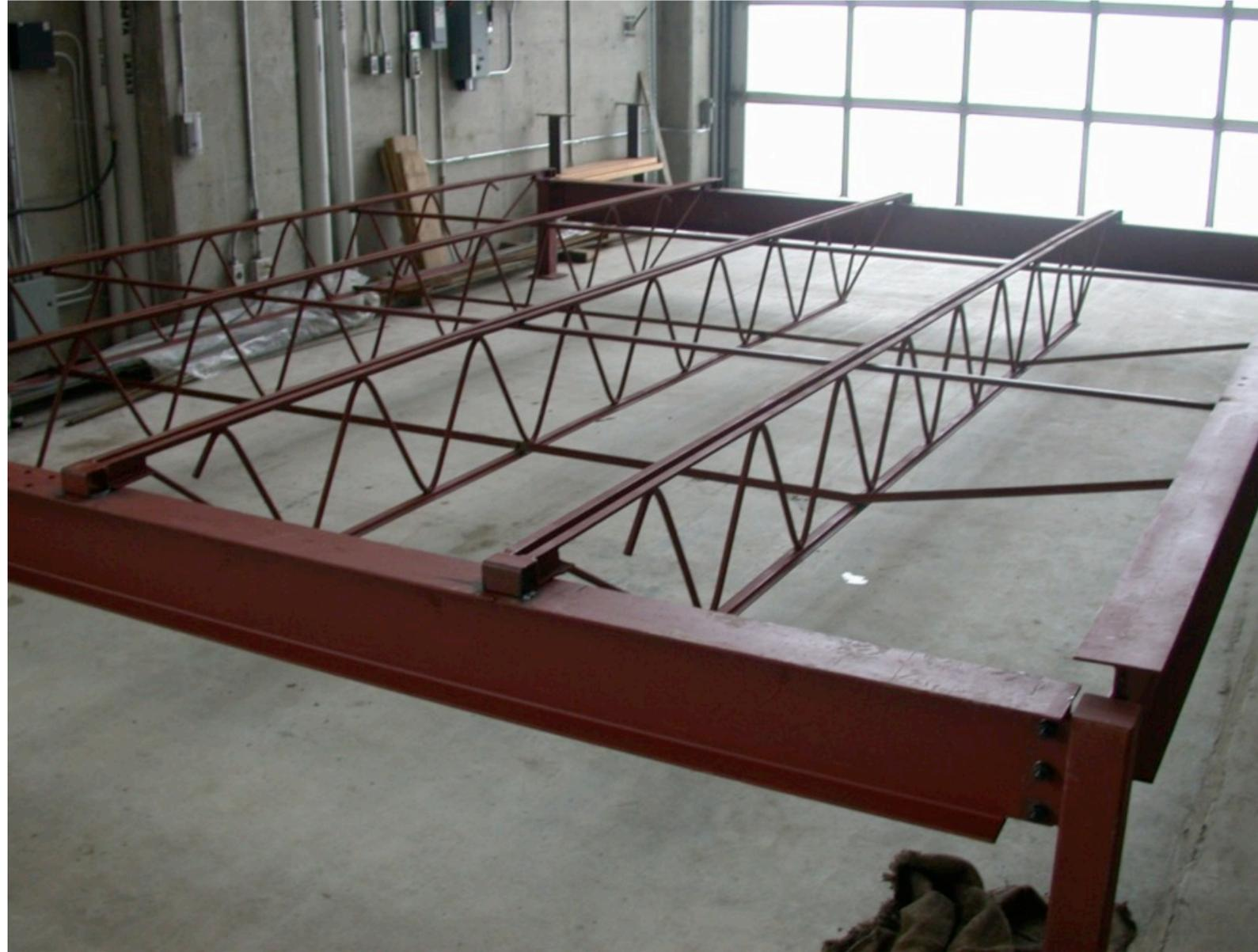
Toiture reconstituée au laboratoire: 2 sections identiques de 20'x16'; chaque section est faite de 3 poutres W 250x59 disposées sur 3 des côtés du périmètre (2x16' + 1x20') et 4 poutrelles Warren de 20' espacées de 4' c/c et reposent sur les 2 poutres parallèles de 16'
