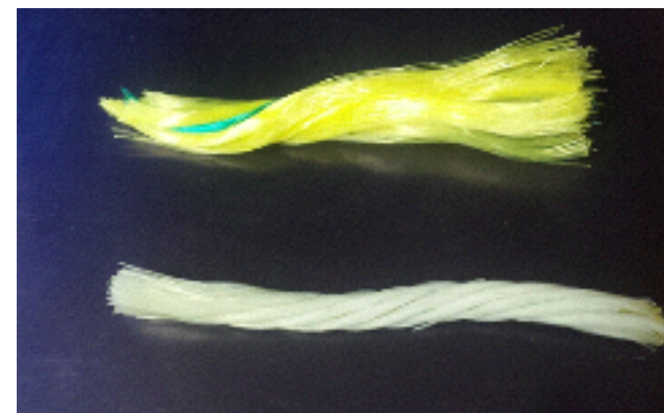
PP reçu (haut) et PP vieilli naturellement pendant 18 mois (bas)
