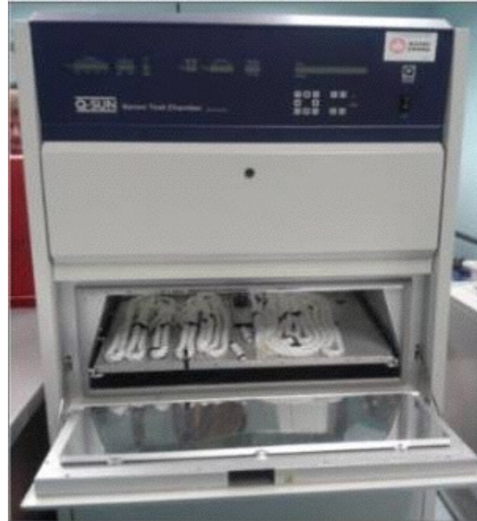
Chambre de vieillissement Q-Sun modèle Xe-3-HSC à lampe de Xénon
